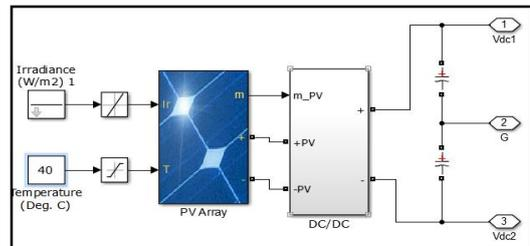
Fig 9a- Solar PV system
