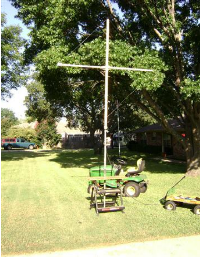
5 ft X 5 ft Mini Receiving Loop
