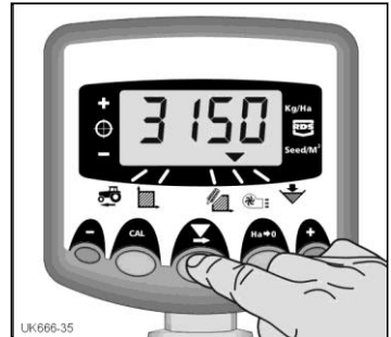
Figura 19: Pantalla Velocidad del Ventilador
