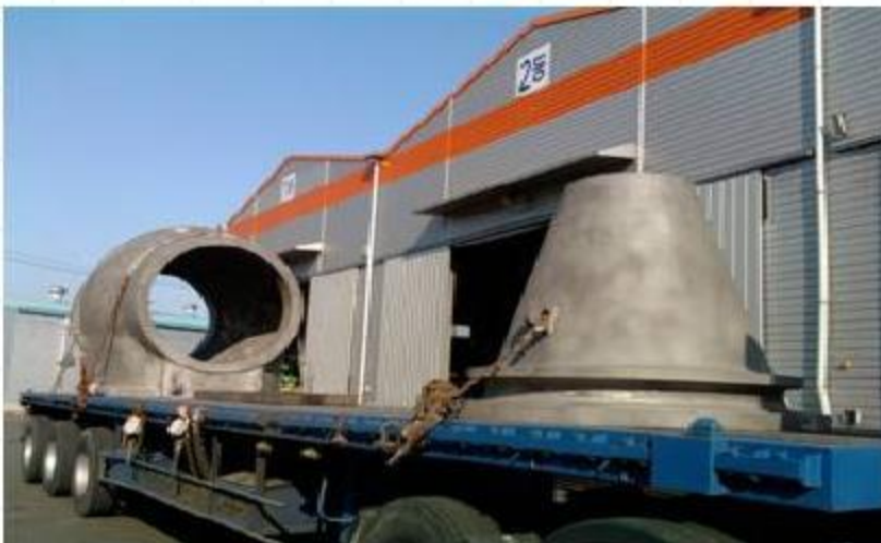
PRV VALVE BODY & INNER CONE: A216 Gr.WCC
