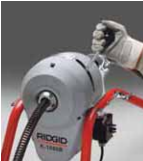
Accione el embrague, el cable girará
