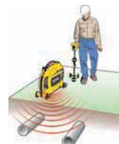
Inducir una señal para localizar líneas de servicios públicos.
