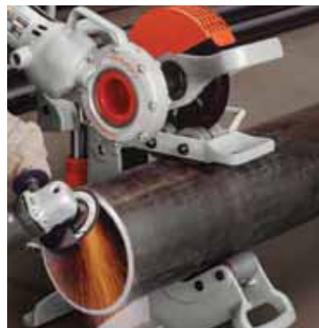
Modelo 258 con rodillo de tuberías durante la realización del biselado. Se recomienda que esta operación la realicen dos operadores.
