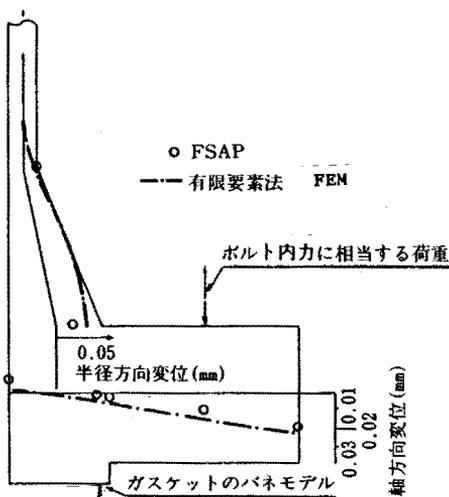
図6 フランジ継手の変形 (FSAPと有限要素法との比較)
