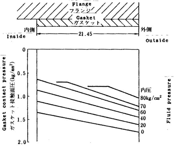
図9 内圧負荷時における接触面圧分布の変動
