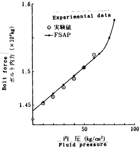
図8 ボルト内力の変化
