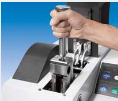
Fácil extracción del brazo triturador sin herramientas
