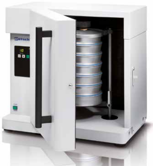
AS 200 tap con cámara de aislamiento acústico y juego de tamices
