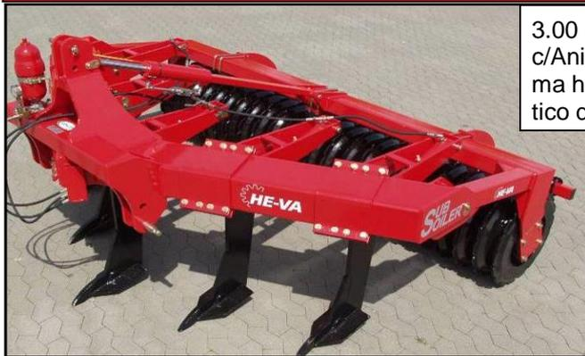
3.00 m, 5 dientes, c/Anillos perfil-V, sistema hidráulico y automático de liberación.
