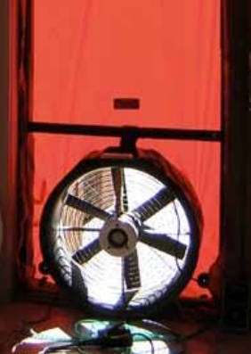
Blower Door Test
