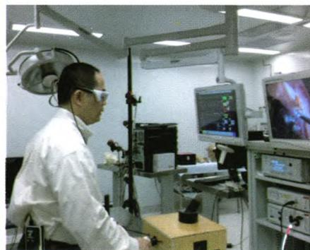
图 1 SSRL 内部完全依照微创手术室而设立,配备手术床、灯光、悬吊臂、影像系统及手术器械。木质训练盒内部放置模拟组织,模拟腹腔镜下胆囊摘除术及患者生命体征。佩戴的眼动仪记录训练者的眼球运动,而三维运动跟踪仪(画面中部远端显示其中的一部分)则记录训练者肢体运动轨迹
