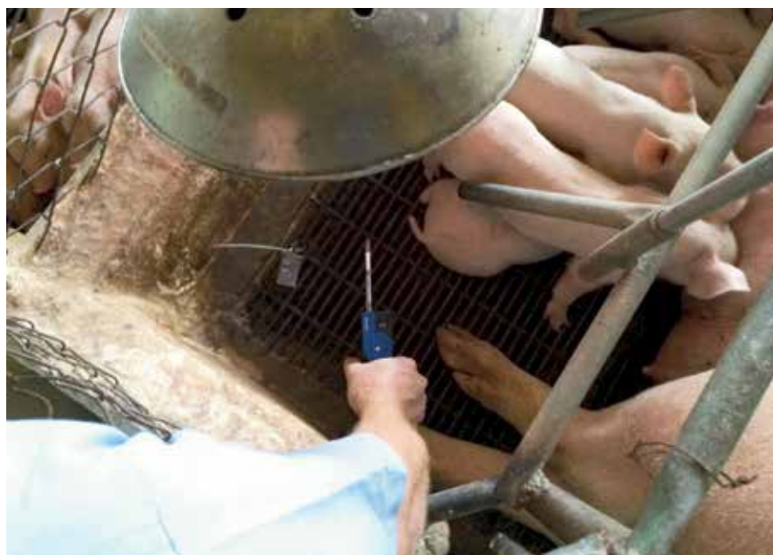
Figura 5. Medición de dióxido de azufre residual en la paridera con la criadora a biogás.
