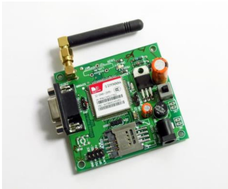
Fig. 4 A GSM/GPRS Module [6]
