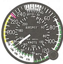
Image 48 - Anémomètre (Airspeed Indicator)
