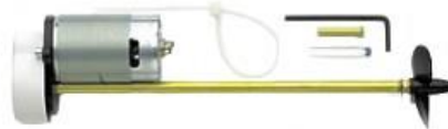
No. 4120 Navy Powerset 600/24 Unidad de alto desempeño con motor clase 600, reductor 3.7:1 y propela de 3 palas de Ø50mm para lanchas sport o modelos funcionales, integrado con la flecha. El motor está montado invertido ahorrando espacio.
