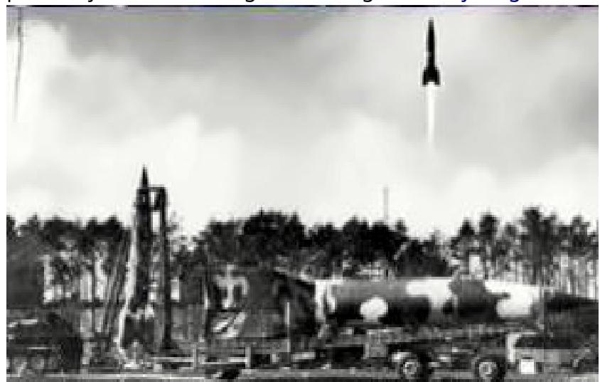
Raketa V-2 od 14 m pokreće se alkoholom i tečnim kiseonikom do visine od 90 km brzinom od 5400 km/h sa dometom od 320 km i opterećenjem od 740 kg. Sve moderne rakete, uključujući raketu Saturn V na Mjesecu, bazirane su na A4 konceptu.
