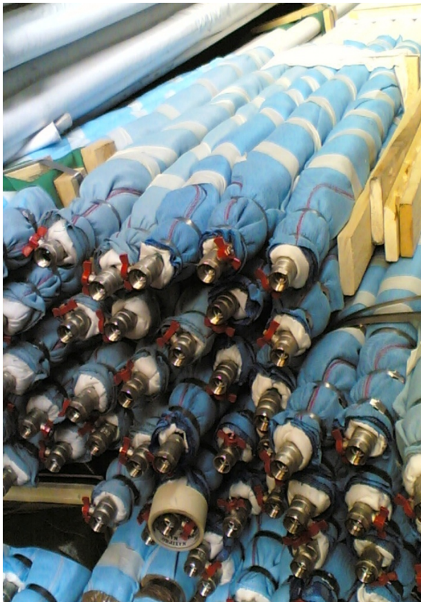
Elementos VTR tubulares con geotextil externo para controlar el volumen de inyección y la adherencia
