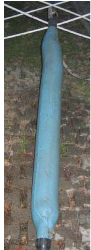
Elementos VTR tubulares con geotextil externo para controlar el volumen de inyección y la adherencia
