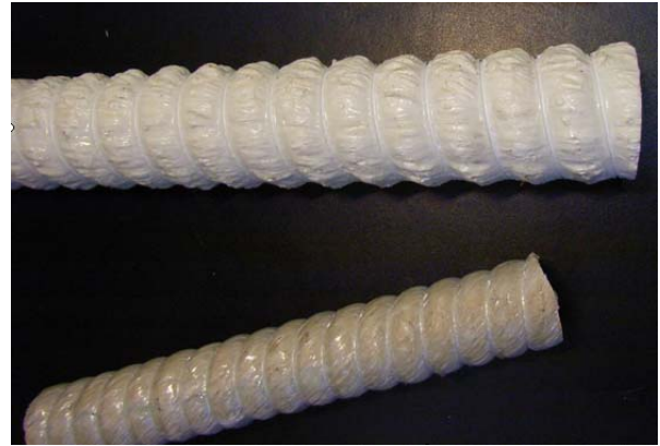
Elementos VTR corrugados de sección circular
