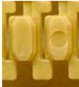
Sunken Ejector Pin Mark
