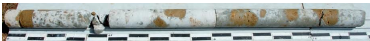
Ultima carota di calcestruzzo estratta dalla pila sperimentale di Brindisi nel novembre 2009
