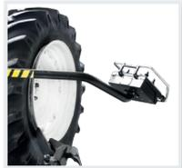
**!** Possibilité d'installation de la console de commande sur le bras pivotant (en option).
