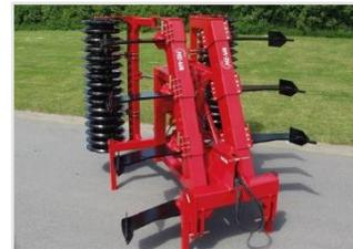
4.00 m doblado hidráulico, 7 púas, anillos perfil-V Rápido Empuje.
