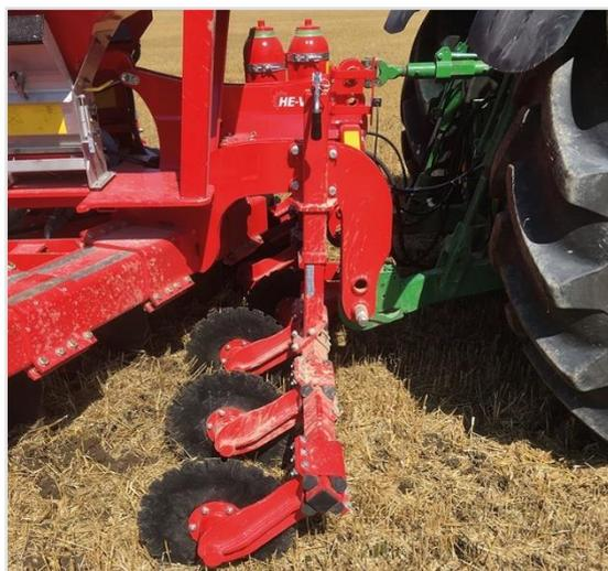
Bastidor para ruedas cortadoras Ø470 mm.
