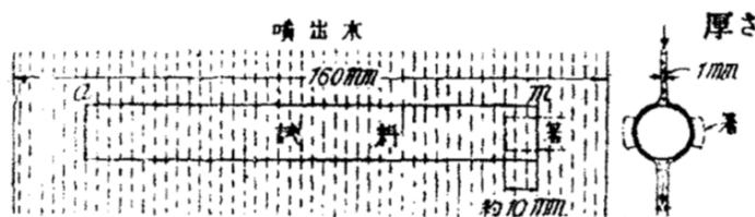
図5 円柱鋼試験片の片側冷却試験
