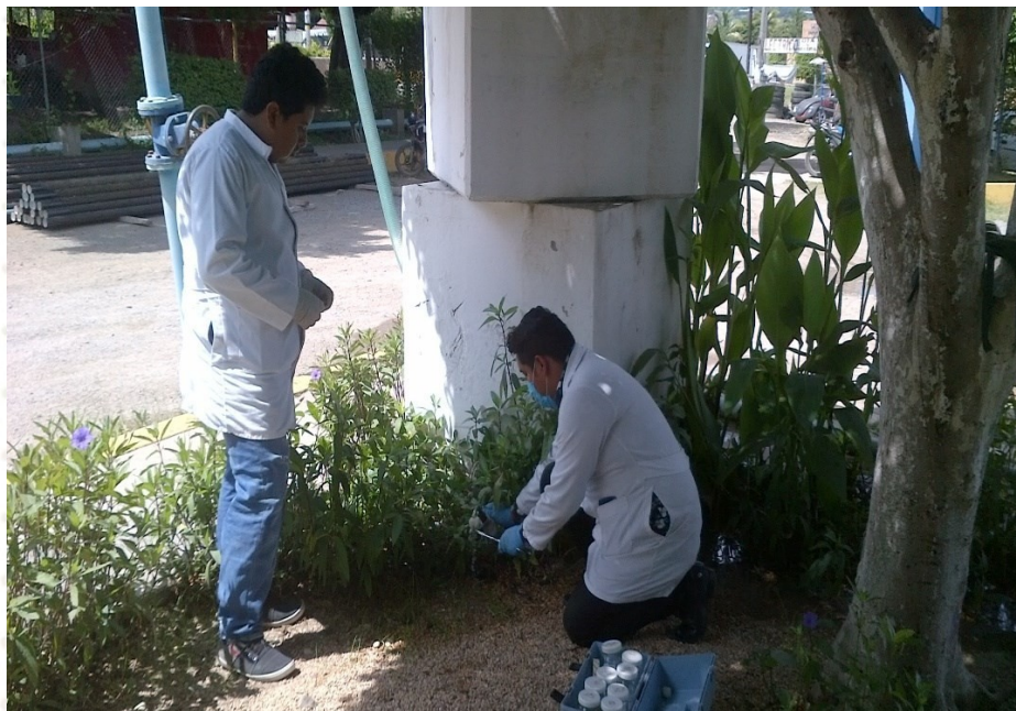
MONITOREO DE CLORO RESIDUAL Y TURBIEDAD DEL AGUA EN PLANTA
