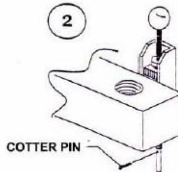
ADJUST ROD HEIGHT WHEN CARRIAGE IS IN REST POSITION
