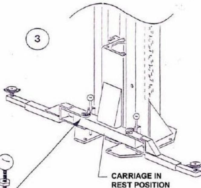
4 USE 9/16 BOXED END WRENCH ON NUT & PLIERS ON ROD (AT THE BOTTOM) TO TIGHTEN NUT DOWN ON GEAR RACK. MAKE SURE GEAR IS ENGAGED.
