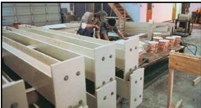
Columnas Dynaform construidas listas para su envío.
