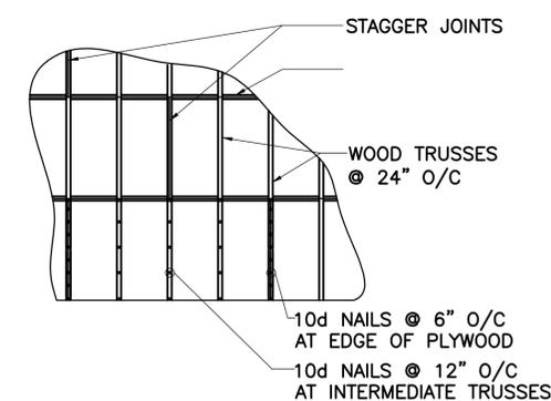
PLAN-ROOF TRUSS NAILING DETAIL
