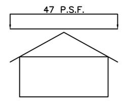
BALANCED & UNBALANCED SNOW LOAD DIAGRAM
