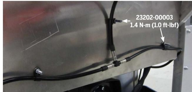
**Figure 65: Brake Line P-Clips**
