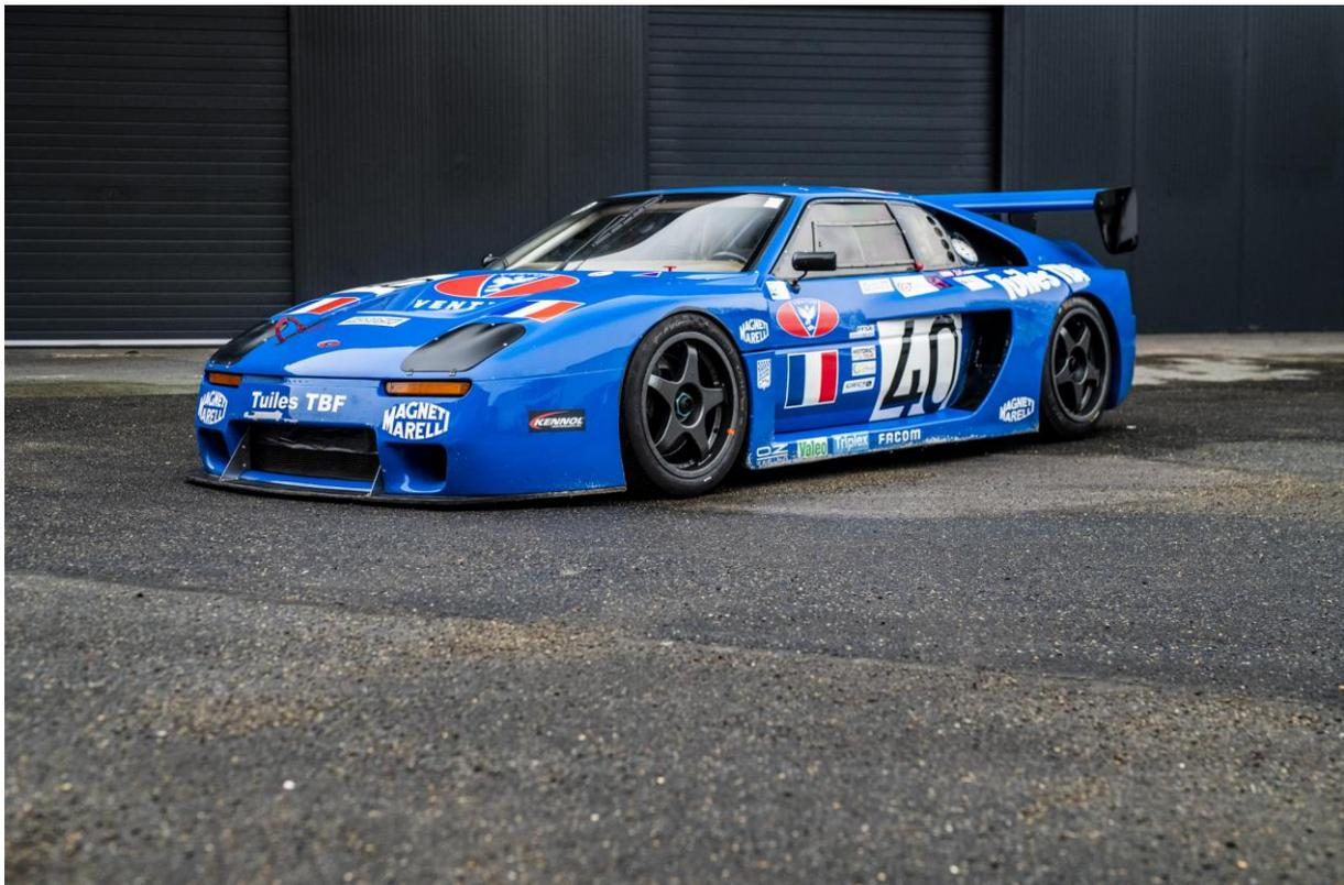
Les évolutions portent sur l'aérodynamique, avec en particulier l'abaissement de l'aileron arrière et un nouveau dessin du bouclier avant résultant de tests effectués en soufflerie. La boîte de vitesse reçoit des pinions renforcés (Hewland DGN), les échangeurs sont modifiés et le moteur est retravaillé de fond en comble par EIA afin d'exploiter le nouveau règlement (nouvelles brides d'admission). La puissance s'élève désormais à 570 chevaux à 1,2 bars de pression de turbo.
