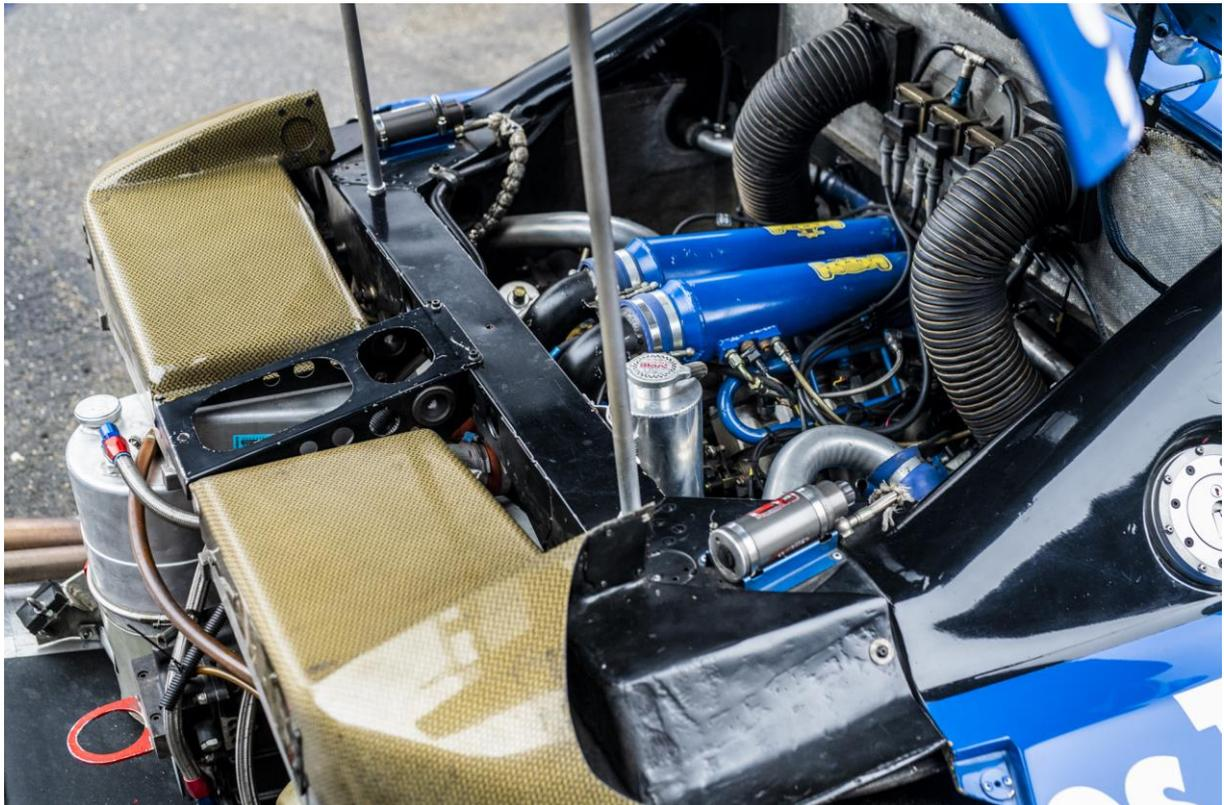
Quant au moteur, il reçoit de nombreuses évolutions : une injection Magnetti-Marelli, un système d'allumage statique, les turbos sont des Garrett F1 avec les waste-gates séparées. La pression des turbos est portée à 1,4 bars au lieu de 1,3 bars. La boîte de vitesse Hewland DGN est remplacée par la boîte Hewland DGC toujours à 5 rapports.
