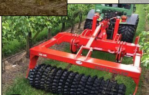
Nuevo 1,8 m Grass-Tiller c/ Rodillo Star o Estrella Ø450/500 mm – ancho total.
