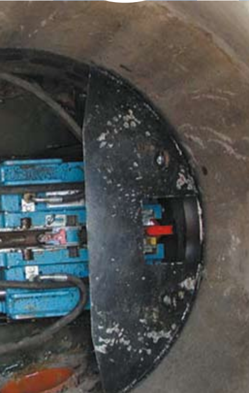
Cabezal de dirección y placa trasera de empuje (Patente en trámite). Las ruedas reducen la fricción y evitan cualquier impedimento ⇒ Más fuerza de empuje.
