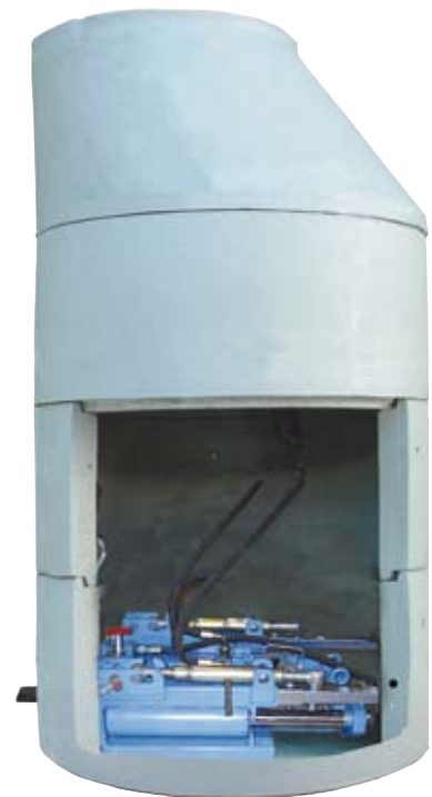
La versión arqueta del GRUNDOBURST 400 S para la sustitución/ renovación con tuberías cortas. Esta máquina está diseñada para poder trabajar en arquetas de 1 metro de diámetro. Según la longitud de la tubería, el Grundoburst se coloca en una plataforma regulable en altura y se apoya sobre la pared de la arqueta.
