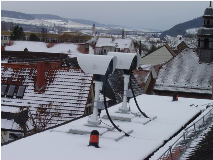
Flachdachkonstruktion für 2 FlightSpectrum-Systeme
