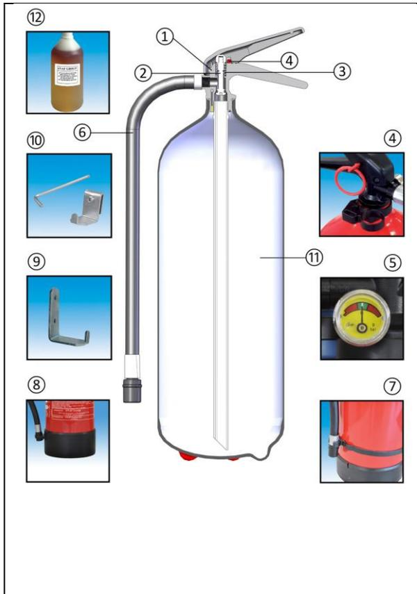
① La vanne est constituée de résine acétal assurant la protection contre la corrosion.
