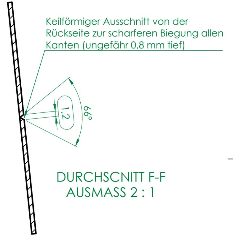
Keilförmiger Ausschnitt von der Rückseite zur schärferen Biegung allen Kanten (ungefähr 0,8 mm tief)
