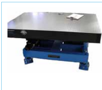
DeutschesElektronen-Synchrotron (DESY-2) Custom Optics Table
