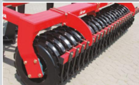
El perfil-V ø600 mm consiste en anillos dentados de acero prensado con un perfil de hombros que asegura una agresiva ruptura de terrones y un acabado de la superficie perfecto. Las traillas montadas entre los anillos hacen posible una preparación del suelo en condiciones húmedas y pegajosas.
