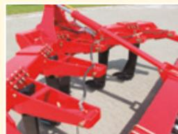
Esta protección contra piedra Rápido Empuje consiste en un perno de seguridad especial diseñado con 8 pasos por perno, que se cortarán si un diente golpea una piedra. Después de la ruptura de un perno, quite la horquilla R - Coloque el perno una muesca hacia adelante y, después de haber montado la horquilla R otra vez, el conductor puede continuar su trabajo - Simple y fácil sin necesidad de utilizar ninguna herramienta.
