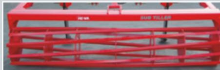
El rodillo de tubo cuadrado ø550 mm - hecho de fuertes tubos seccionales - asegura un excelente control de profundidad y rompe los terrones en suelos ligeros.
