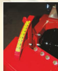
La profundidad de trabajo es controlada de modo exacto mediante el hidráulico del rodillo. Con la escala de profundidad el tractorista puede ver exactamente la profundidad de trabajo actual.
