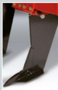
El Sub-Tiller HE-VA puede trabajar en profundidades desde 0mm hasta un máx. de 600mm. Los puntos de desgaste tienen aletas de 200mm permitiendo el levantamiento y roturamiento de la tierra a la profundidad de trabajo escogida. El diseño de los dientes evita el llevar piedras y terrones indeseados a la superficie.
