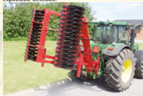
Los modelos de 4 m y 5 m pueden ser plegados siendo el ancho de transporte 2,43 m.
