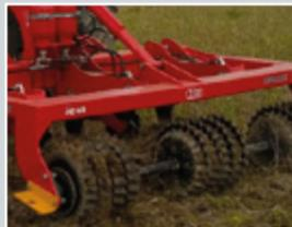
Rodillo estrella 450/500 mm (sincrónico, 300 mm de ancho) construido de anillos de acero fundido dejando el terreno plano y suelto.
