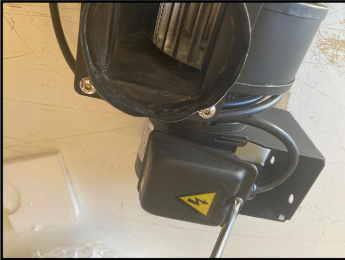
**1. USING A SCREWDRIVER REMOVE THE COVER OVER THE ELECTRIC BOX ON CHAFF FAN.**
