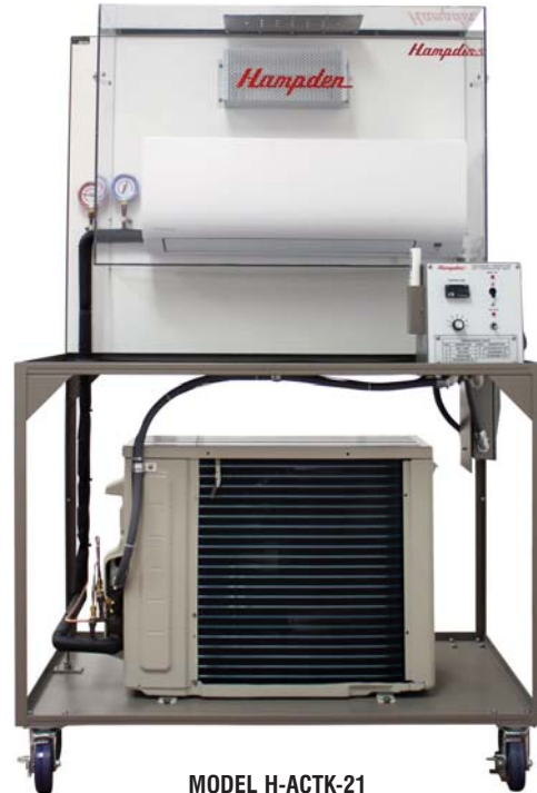
MODEL H-ACTK-21 Mini Split-Type Air Conditioner Trainer
