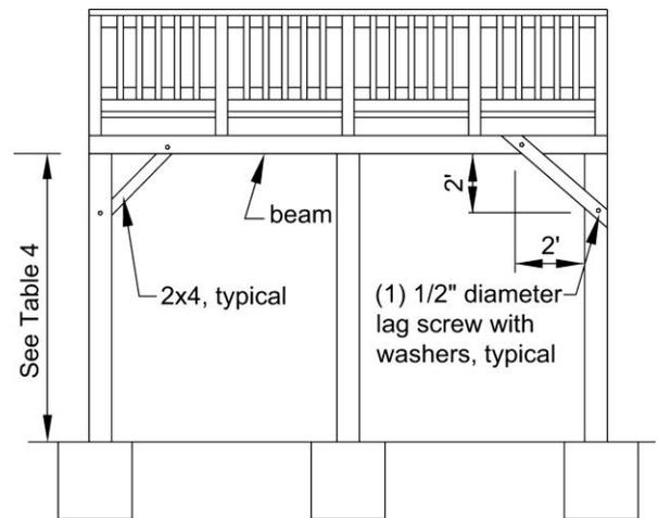
DIAGONAL BRACING PARALLEL TO BEAM
