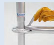
Para asegurar la rigidez del conjunto, se golpearan las cuñas de los largueros y diagonales, una vez presentado el módulo base. Un golpe de martillo en la cuña, transforma la unión en una unión segura y origina una gran fuerza de sustentación para todo el sistema
