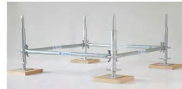
**Paso 4 ► Nivelación del Marco Base:** Mediante un nivel de burbuja o similar se nivelará y se ajustará el marco base del andamio, girando la "palometa" o "mariposa" del tornillo regulable. Siempre se comenzará por el punto más alto de la base o del terreno y se seguirá una secuencia ordenada (reloj o contrarreloj) hasta finalizar en el punto donde se inició la nivelación.
