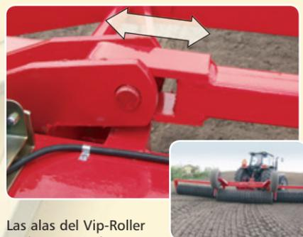
Las alas del Vip-Roller están conectadas a la sección central para girar, de forma controlada, siguiendo la línea de nivel del terreno.
