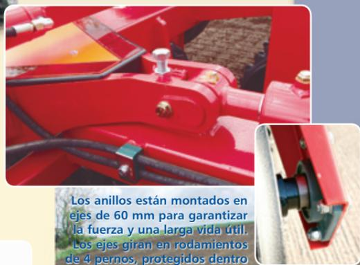
Los anillos están montados en ejes de 60 mm para garantizar la fuerza y una larga vida útil. Los ejes giran en rodamientos de 4 pernos, protegidos dentro de un perfil de acero en U.
