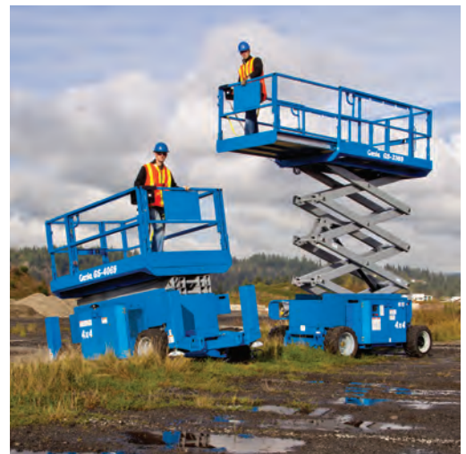
Los modelos de la serie GS-69RT tienen una extensión de cesta entre 91 cm y 1,52 m.
