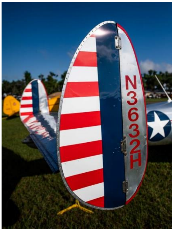
The Twin Tail on an Ercoupe
