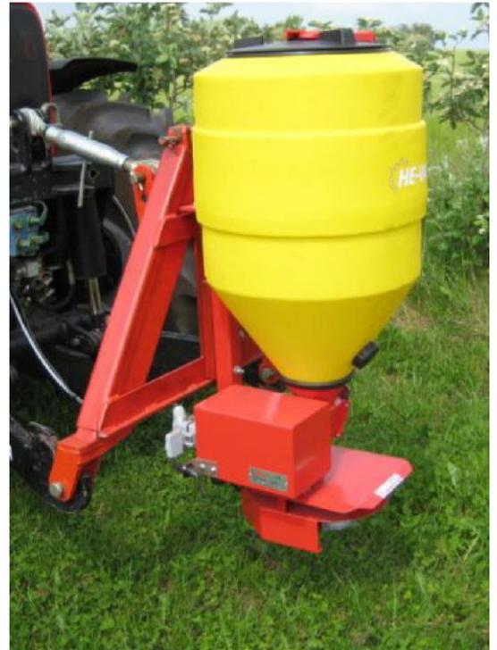
Cada semilla tiene su propio carácter de vuelo, en consecuencia es útil el ajuste del radio de difusión. Adicionalmente se puede también ajustar las cuchillas lanzadoras en el plato esparcidor. Si usted rota las cuchillas hacia la derecha (visto desde arriba) la semilla toma hacia la izquierda. Ajustando de nuevo hacia la izquierda el efecto es opuesto.
