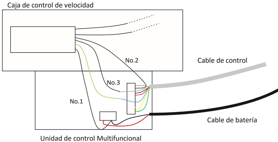
**Conectando la caja de control de velocidad con la unidad de control multifuncional:**
