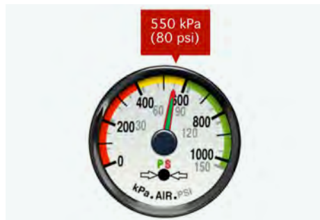
FIGURE 70 | Manomètre indiquant une pression de 550 kPa (80 lb/po 2 )
