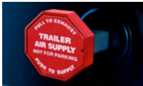
FIGURE 64 | Commande d'alimentation en air de la remorque
