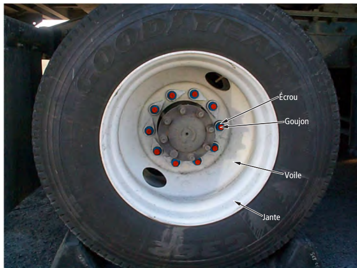
FIGURE 44 | Roue à disque ( budd wheel )
