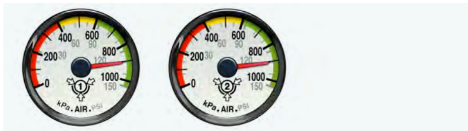
FIGURE 62 | Manomètres à air comprimé
