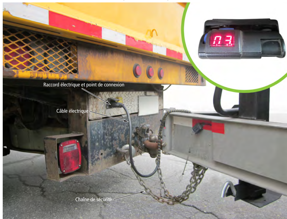
FIGURE 55 (en médaillon) | Contrôle d'intensité pour freins électriques
