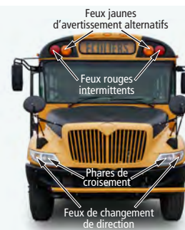
FIGURE 32 | Phares et feux avant d'un autobus scolaire
