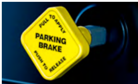
FIGURE 65 | Commande d'alimentation en air du frein de stationnement
