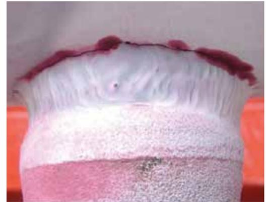
Ensayo de tintas penetrantes que evidencia una fisura en la soldadura.
