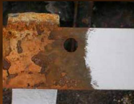
Ejemplo de utilización de los revestimientos Converttech directamente sobre la pieza oxidada.
