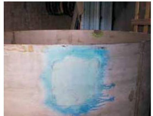
Contaminación ferrítica detectada con Ferritech en la construcción de virolas de TKS.
