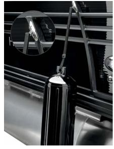
QUICK RELEASE FENDER SYSTEM (MID-SHIP QUICK RELEASE AVAILABLE ON SOLSTICE, GRAND MARINER AND CROWNE)
