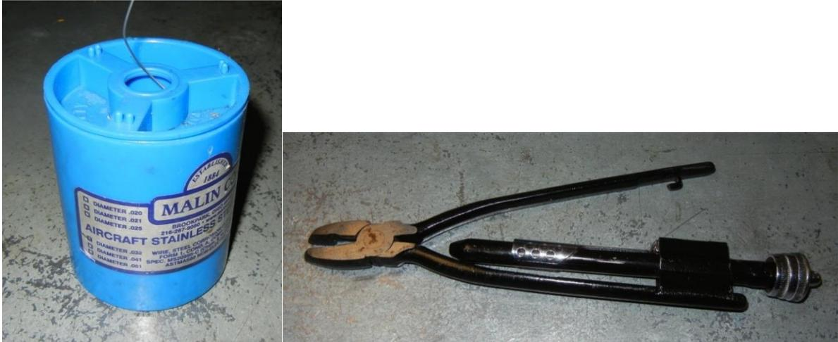
**Figure 9 – Safety Wire / Wire Pliers**
