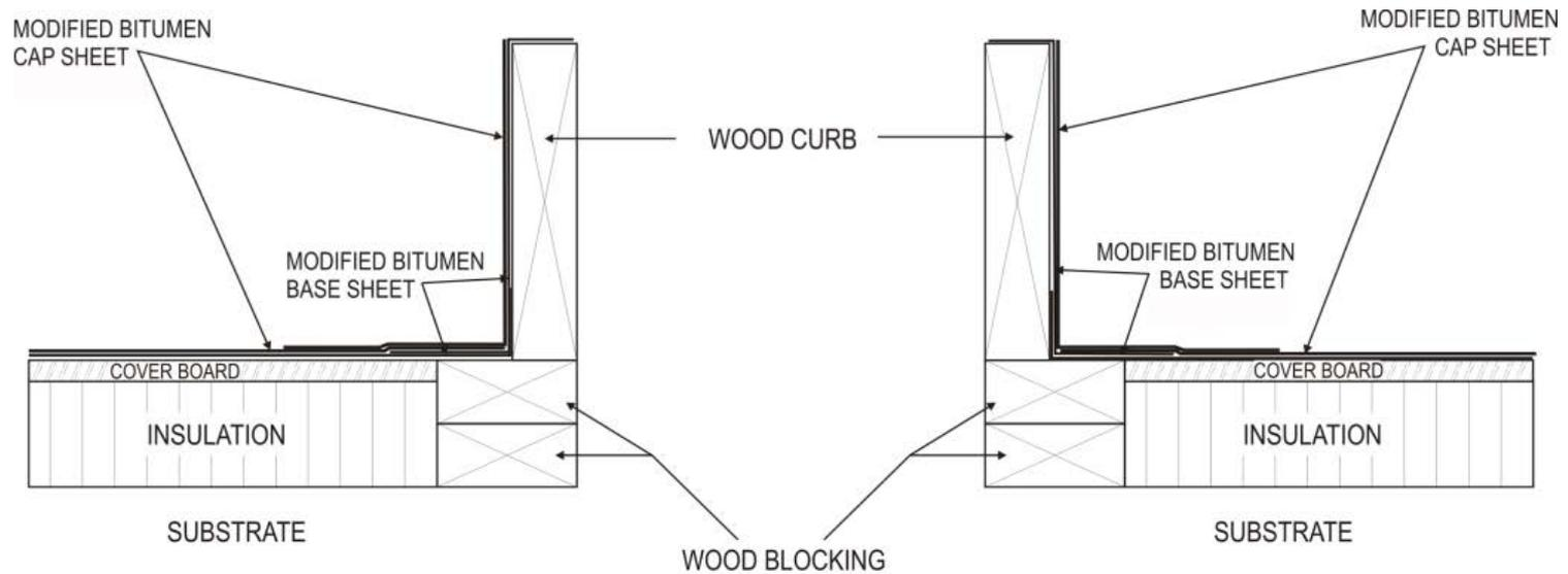
TYPICAL WOODEN CURB FOR MODIFIED BITUMEN MEMBRANES
