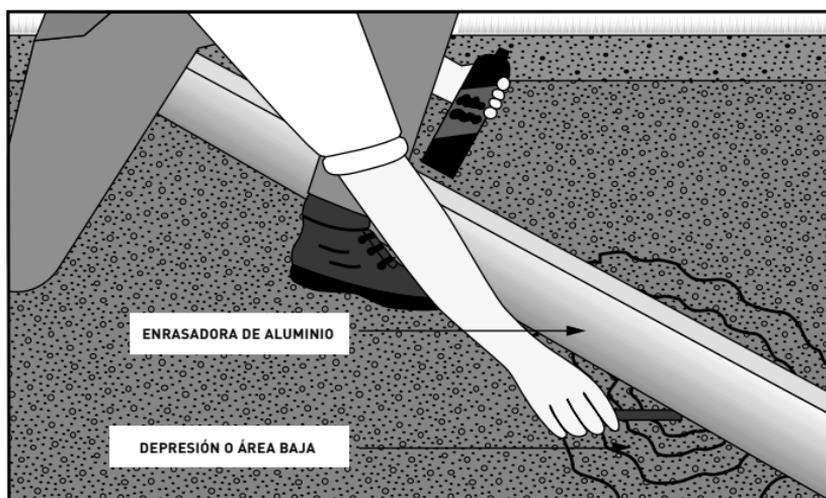
Figura 16. Verificación de niveles con la enrasadora.
