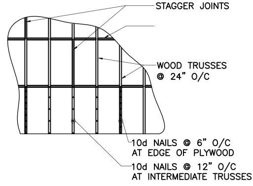
PLAN-ROOF TRUSS NAILING DETAIL AS5.03 | 1 | SCALE : 1/4" = 1'-0"
