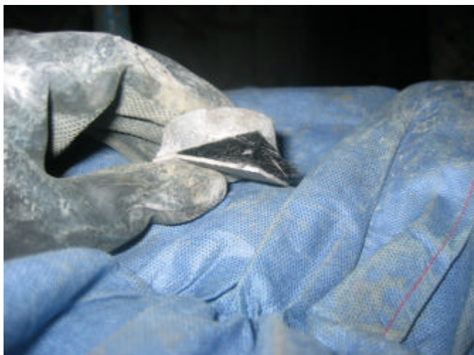
Ilustración 6.- Ensayo de control de calidad con mala impregnación del material compuesto.
